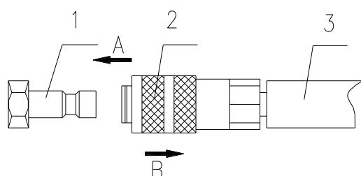
**1 conector del distribuidor de gas    2 Conector    3 Tubo de gas**
