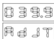
5. El instrumento se calentará hasta el siguiente punto de temperatura de  $80^{\circ}\text{C}$ ; repita los pasos anteriores para calibrar.
