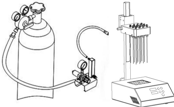
Conecte la válvula de flujo de aire con el distribuidor de gas mediante un tubo de gas más corto (1.5M), conecte la válvula de flujo de aire con el generador de gas mediante un tubo de gas más largo (3.0 M).
