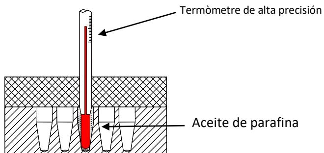
3. Presione los botones y de Temp para comenzar la calibración. La ventana de tiempo muestra "Adjt", la temperatura muestra la temperatura instantánea del bloque con el punto parpadeando, y el instrumento comienza a calentarse hasta  $40.0^{\circ}\text{C}$ .
