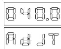
**Nota:** Mantener el instrumento calentando a una temperatura de  $40.0^{\circ}\text{C}$  al menos durante 20 minutos ayudará al instrumento a obtener una temperatura precisa.
