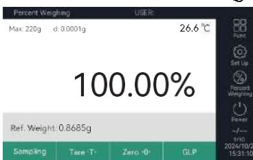
Sélectionnez « 0 » pour remettre la balance à zéro si nécessaire.
