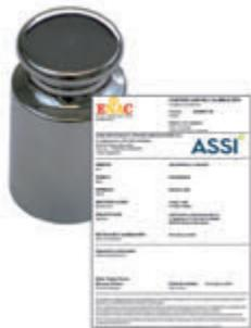
**PESO DI PRECISIONE CLASSE M1 IN ACCIAIO INOX****METRIA**
