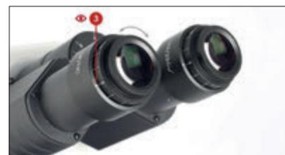
3 - Guardare con l'occhio sinistro attraverso l'oculare sinistro. Utilizzare l'anello di regolazione delle diottrie per mettere a fuoco e focalizzare il campione fino a quando l'immagine è nitida.
