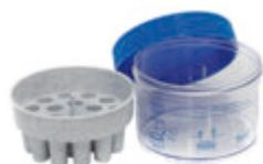
Progettato per l'uso con tubi criogenici fornisce un raffreddamento semplice dei campioni alla velocità ottimale per preservare le cellule. Realizzato con un contenitore in polycarbonato, supporto e chiusura per tubi in HDPE e inserto in schiuma, offre una velocità di raffreddamento critica e ripetibile di -1 °C al minuto, necessaria per una crioconservazione e recupero cellulare di successo. Include inserti per tubi da 1,0, 1,8 e 2,0 ml, con una capacità di 18 tubi
