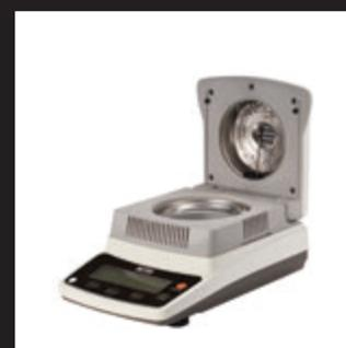
Analizzatore di umidità (MMB), campioni fino a 120 g con risoluzione di 0,001 g / 0,01 %.
