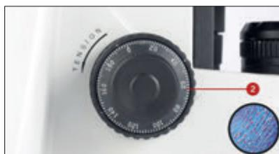
2 - Focalizzare l'immagine utilizzando le manopole di regolazione macro e/o micrometriche fino a quando l'immagine del campione è nitida
